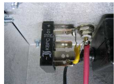
BNC-Eingangsbuchse von MOPA-Leistungsverstärker (Fa. GB 4000) für die Rife-Frequenzbehandlung mit zus. Brückengleichrichter als Schutz für d. Frequenzgenerator: Minus-Anschluß an Eingang und Plus-Anschluß an Masse!
